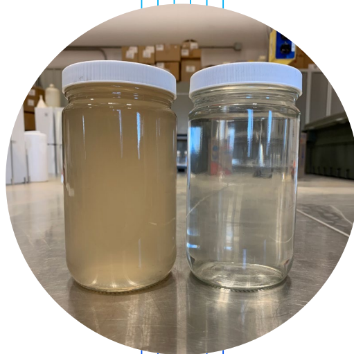
Eaux de mine issues de l'exploitation des sables bitumineux avant et après leur traitement.
